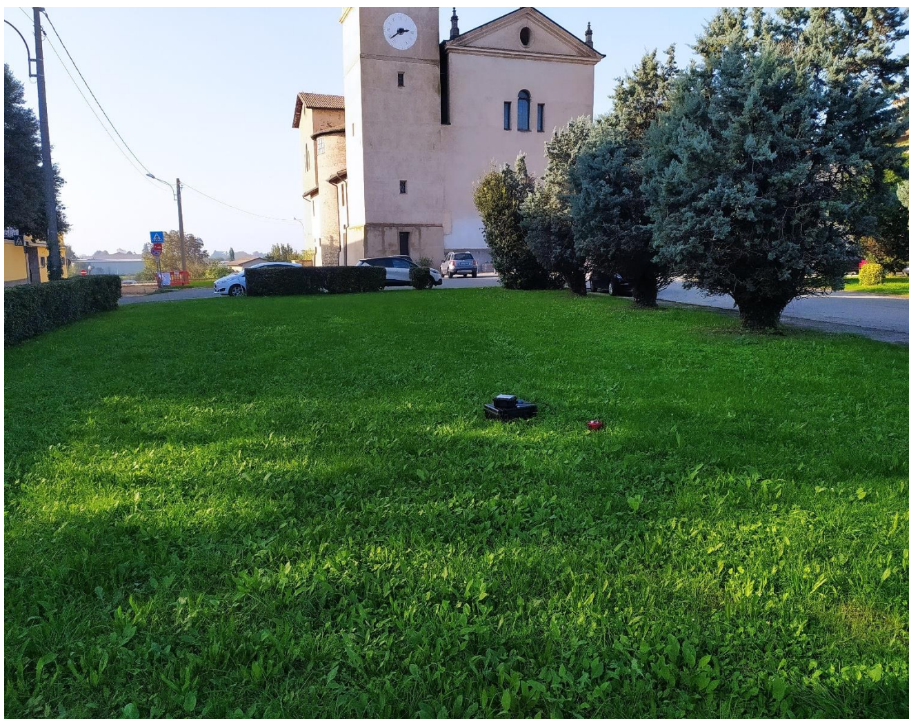
FIG. 5 – FOTOGRAFIA DEL TROMOGRAFO DURANTE L'ACQUISIZIONE DI UNA PROVA HVSR
