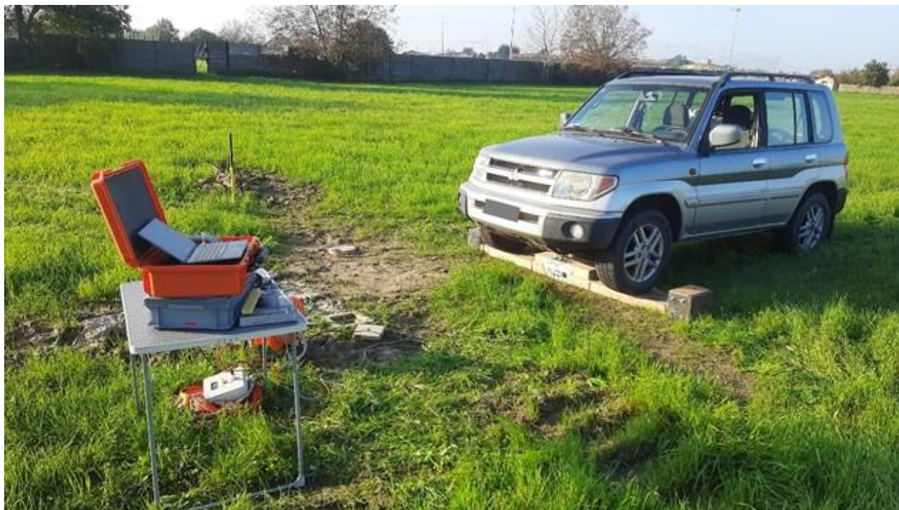
FIG. 3 – REALIZZAZIONE DELLA PROVA SISMICA DOWN-HOLE IN COMUNE DI BIBBIANO
